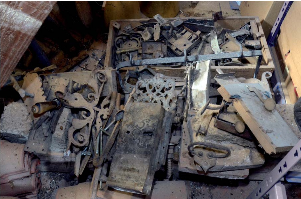
Schlecht: Die Metall-Beschläge von alten Türen sind falsch gelagert worden. Jetzt kann man sie nicht mehr benutzen.
